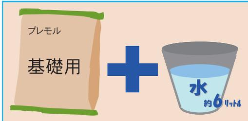
プレモル基礎用1袋に対し、標準水量約6リットルの清水を加え、5分間以上混練してください。
